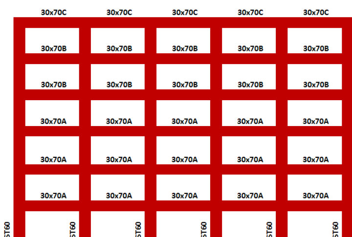
Fig.4.3. Dimensiuni ale elementelor pentru structura P+5E
